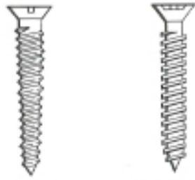
Tornillo para madera (izda.) y tornillo para tableros (dcha.) © MDF Users manual
