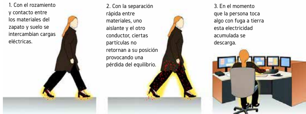
Figura 1: Proceso de descarga electroestática de un pavimento.
