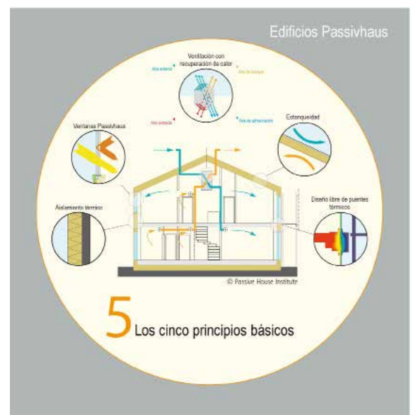
FIG 1_Principios Básicos Passivhaus_fuente PH Institut
