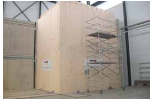
Fig. 7 Laboratorios para la medida de transmisiones por flancos (Fuentes NRC, EMPA)
