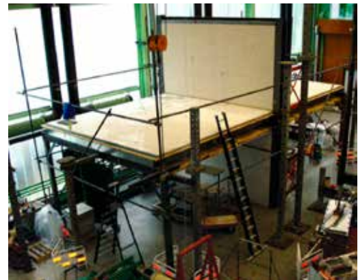
Fig. 7 Laboratorios para la medida de transmisiones por flancos (Fuentes NRC, EMPA)
