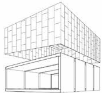
Se elige el cerramiento 3 Láminas metálicas microperforadas
