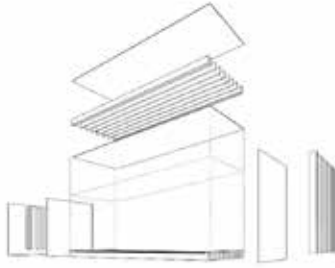
Costillas estructurales y paneles contrachapados
