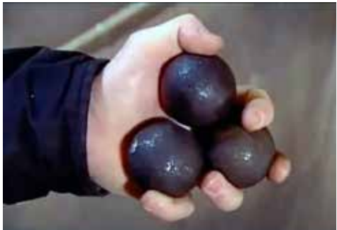
Bolas de acero para moler la arena © James Hardie
