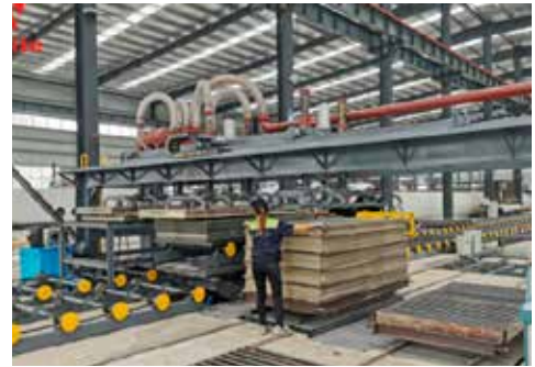
Desapilado de tableros
