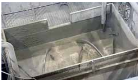
Batido en la mezcladora con aspas curvas
