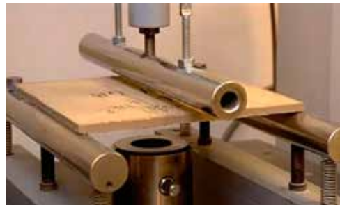
Control de calidad (ensayo de resistencia a flexión) James Hardie
