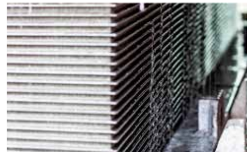
Deshidratado por prensado y detalle del chorreado del agua en el prensado Swisspearl
