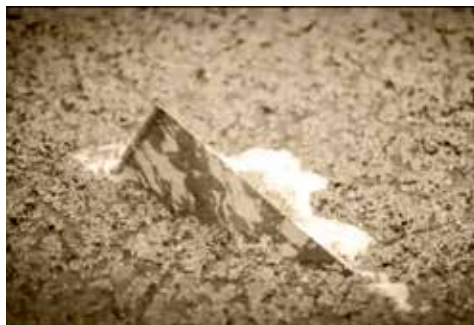
Disolución de las hojas de celulosa en el agua © James Hardie
