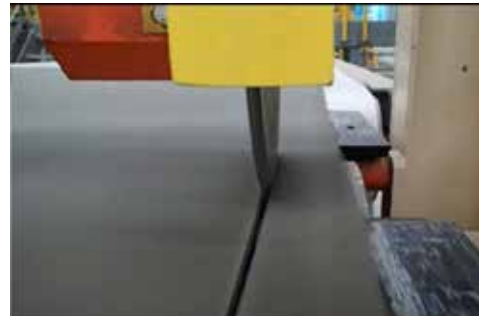
Corte longitudinal de la manta con sierra circular © MMFL
