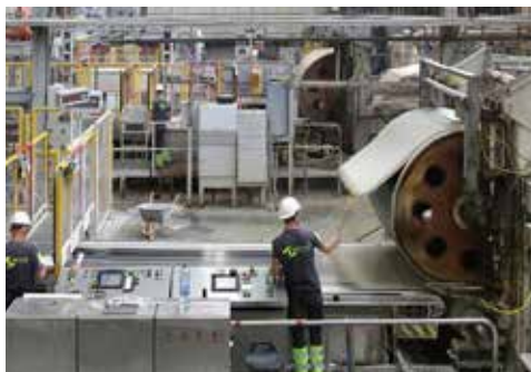
Corte de la manta del rodillo formador © Equitone
