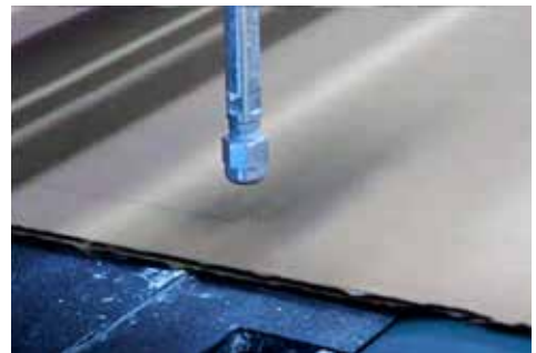
Corte longitudinal de la manta con chorro de agua a presión © Wehrhahn GmbH
