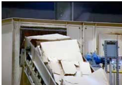
Pacas de fibra de celulosa vertidas para ser hidratadas © James Hardie
