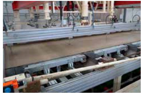
Corte transversal de la manta con chorro a presión © Wehrhahn GmbH
